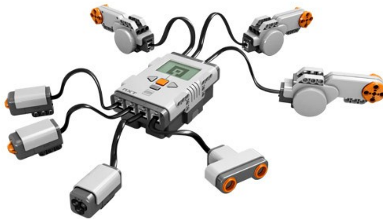
Cervell amb diversos servomotors i sensors
